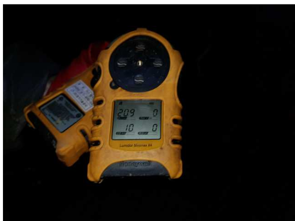
내용 출입전 산소 농도 측정
