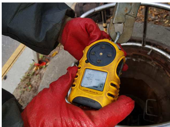
내용 출입전 산소 농도 측정
