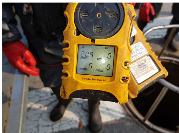
내용 출입전 산소 농도 측정
