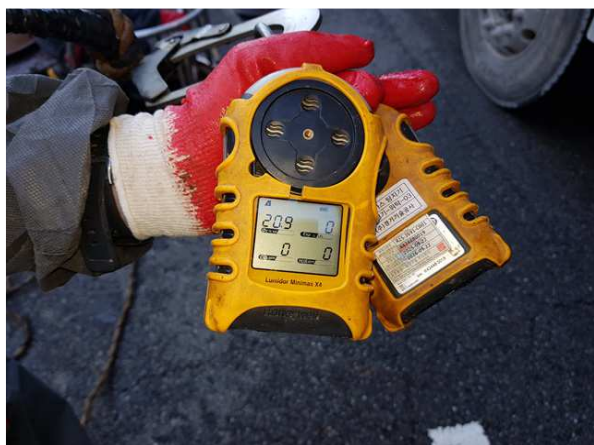
내용 출입전 산소 농도 측정
