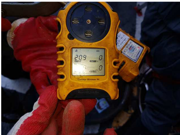
내용 출입전 산소 농도 측정
